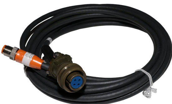
Abbildung 12: Mit ValveExpert Checker 2.4 können klassische Servoventile mit mechanischer Rückmeldung und Steuersignal bis zu -20mA \dots +20mA gesteuert werden. Die Abbildung zeigt ein Kabel für Servoventile, die der Moog 760-Serie ähneln (standardmäßig nicht enthalten).
