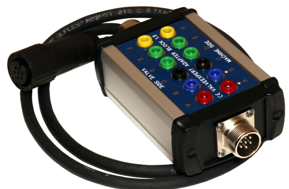
Abbildung 13: Mit dem ValveExpert Adapter 1.5 können alle Signale mit einem externen Multimeter oder Oszilloskop überprüft werden (standardmäßig nicht enthalten). Der Adapter enthält auch LED-Anzeigen für die positive und negative Stromversorgung.
