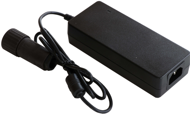
Abbildung 6: Netzteil (Eingang: 90...240VAC, Ausgang: 24VDC, 3.75A, 90W). Siehe Tabelle 3 für die Belegung der Pins. Es werden ausschließlich Pin A und Pin B benutzt.
