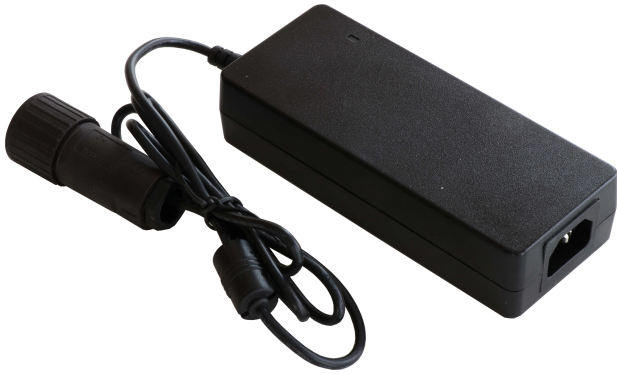
Abbildung 6: Netzteil (Eingang: 90...240VAC, Ausgang: 24VDC, 3.73A, 90W). Siehe Tabelle 3 für die Belegung der Pins. Es werden ausschließlich Pin A und Pin B benutzt.
